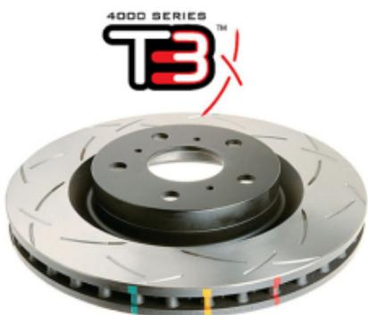
**DISQUES AVANT DBA 4000 SERIES T3 315MM
